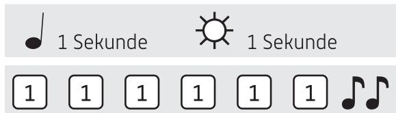
Während des Öffnungsfensters blinkt die Lampe im Sekudentakt und gleichzeitig ertönt ein Signal. Um das Schloss zu öffnen, muß während des Öffnungsfensters ein gültiger Code eingegeben werden. Bei richtiger Eingabe ertönt ein doppeltes akustisches Signal; jetzt können Sie die Tür entriegeln und öffnen. Wenn das Schloss nicht innerhalb von 3 Sekunden geöffnet wird, verriegelt das Schloss wieder automatisch.
